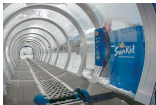
Bedienterminal in der Galerie – hier bei Ausstiegsüberdachung
